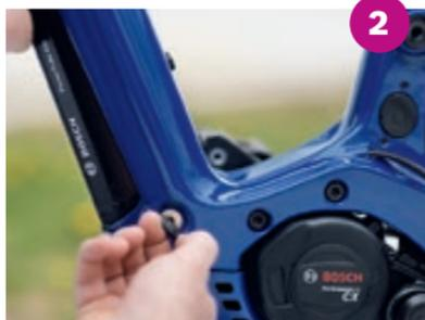
Sbloccandola mediante la chiave (a seconda del produttore), la batteria cade appoggiandosi sul supporto che la blocca.
