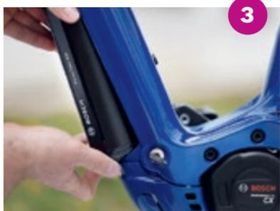
Staccare la batteria dalla protezione mediante pressione dall'alto; la batteria cade nella mano
