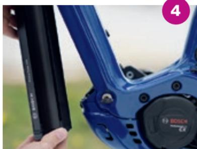
Estrazione della batteria dal telaio
