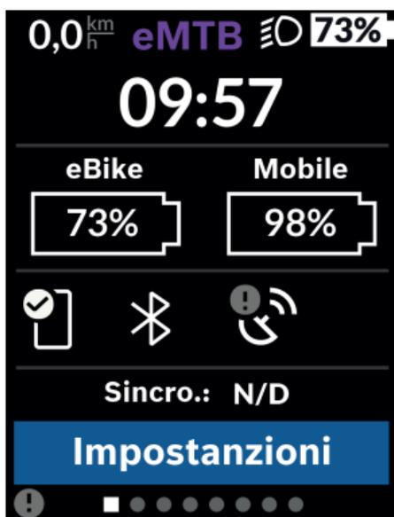
Nella schermata di stato vengono visualizzati, oltre alla barra di stato, l'ora attuale, il livello di carica della batteria dell'eBike e il livello di carica della batteria del vostro smartphone, qualora lo smartphone sia collegato via *Bluetooth®*.
