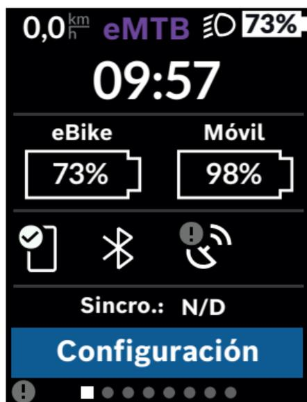
Además de la barra de estado, la pantalla de estado muestra la hora actual, el estado de carga de todos los acumuladores de su eBike y el estado de carga de la batería de su teléfono inteligente, en caso de que esté conectado a través de *Bluetooth®*.
