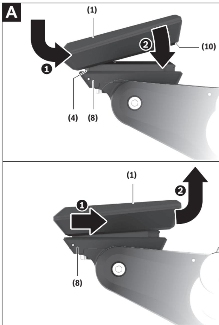
Zum **Aufsetzen** des Displays **(1)** setzen Sie das Display **(1)** an der in Fahrtrichtung vorderen Kante der Display-Aufnahme **(8)** am Rasthaken **(4)**
