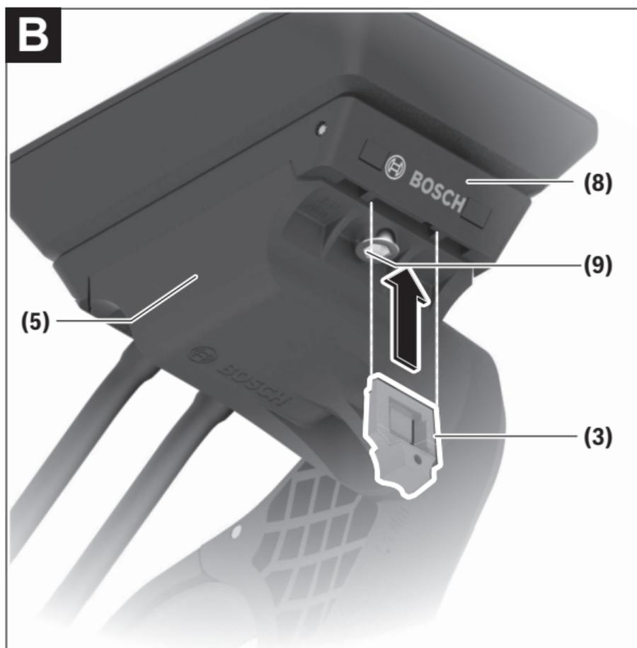
**Hinweis:** Abhängig von Konstruktion/Einbau der Display-Aufnahme kann es sein, dass die Sicherungsplatte nicht eingesetzt werden kann. Das Display muss dabei montiert sein.
