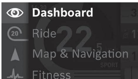
Prin apăsarea și împingerea spre stânga a joystick-ului (1) puteți estompa modul de funcționare activ, acoperindu-l cu meniu principal și puteți efectua modificări în cadrul meniului principal (consultați imaginea din partea superioară).
