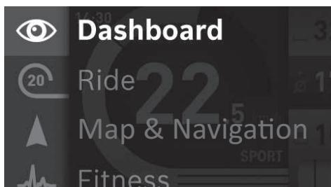
Pomocí joysticku (1) můžete stisknutím doleva aktivní provozní režim překrýt hlavní nabídku a přejít do hlavní nabídky (viz obrázek výše).
