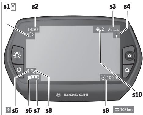
**s1** Indicator iluminare bicicletă/indicator nivel încărcare acumulator Nyon
