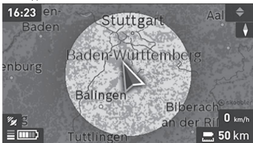
La visualizzazione della sola autonomia residua della batteria può essere ampliata mediante la funzione Premium «Autonomia TOPO». Con «Autonomia TOPO», l'autonomia residua della batteria verrà calcolata e visualizzata in funzione delle condizioni geografiche.
