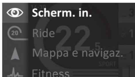
Con il joystick **1**, premendo in senso antiorario, è possibile sovrapporre la modalità operativa attiva con il menu principale e passare a questo menu (vedere figura in alto).
