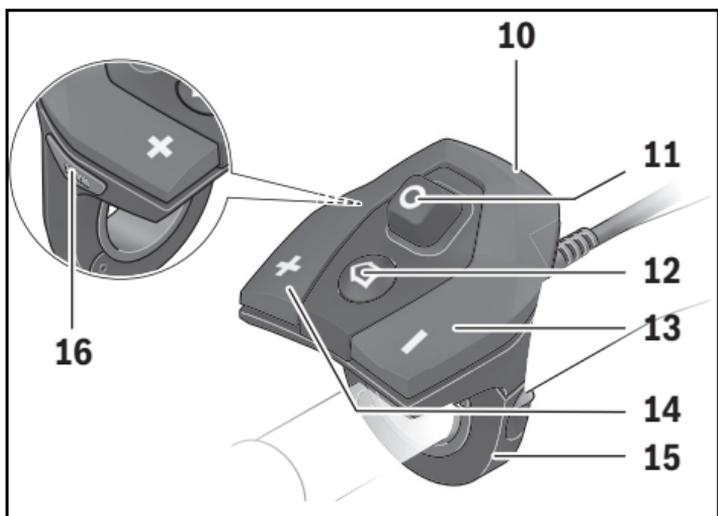
Sull'unità di comando **10** è possibile impostare il livello di supporto del motore eBike durante la pedalata. Il livello di supporto può essere modificato in qualsiasi momento, anche durante la marcia.
