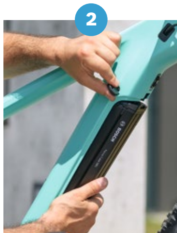
Via de ontgrendeling van de accu met sleutel valt de accu terug in de veiligheidsborging
