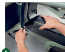
1 I PowerPack sono fissati al telaio. Per rimuovere il PowerPack, apri il dispositivo di sblocco con la chiave in dotazione. Tieni sempre in mano il PowerPack.
