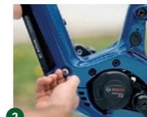
2 Sblocca il PowerTube con la chiave. In questo modo si stacca dal telaio. Un fermo ne impedisce la caduta.
