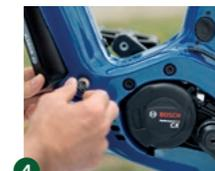
4 Reinstalla la batteria seguendo i passaggi in ordine inverso. Potrebbe essere necessario girare la chiave in dotazione.
