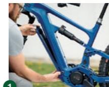
1 I PowerTube sono installati nel telaio. Per rimuoverli, apri il coperchio del telaio (se presente).
