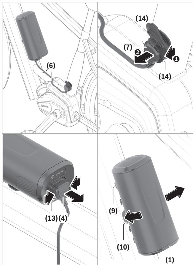
Commencez par dégager le câble (6) de ses attaches/clips conformément aux indications du fabricant de VAE.
