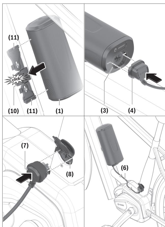
Para **insertar** la batería (1), colóquela con las ranuras guía (12) contra los carriles guía (11). Asegúrese de que la batería está correctamente alineada e insertada en ambos carriles guía. Introduzca la batería (1) en el soporte (9) hasta que encaje de forma audible.
