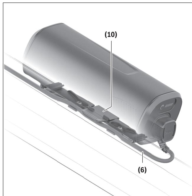
**Remarque :** Veillez lors de la pose du câble (6) à faire passer le câble (6) sous la touche de déverrouillage (10). Cela évite que la touche de déverrouillage (10) soit actionnée par mégarde et que la batterie PowerMore ne soit pas déverrouillée.
