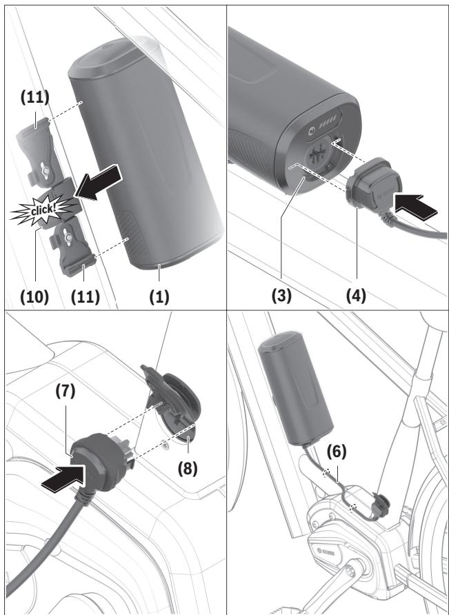
Pour **mettre en place** la batterie (1), positionnez ses rainures de guidage (12) au niveau des rails de guidage (11). Veillez à orienter la batterie dans le bon sens et à l'insérer dans les deux rails de guidage.
