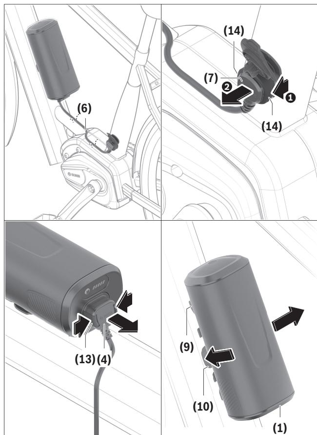
En primer lugar, afloje el cable (6) abriendo la protección del cable según las especificaciones del fabricante de la eBike.
